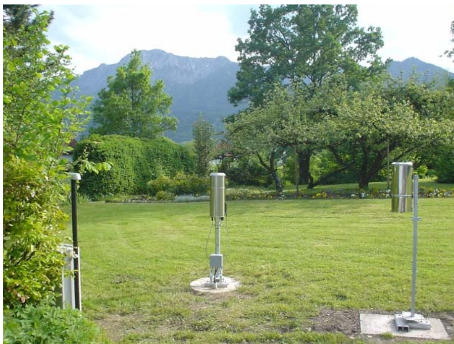
Abbildung 3-9: Niederschlagsmessstelle Schlehdorf mit den Messgeräten: Links: Stationsrechner mit ISDN-Anschluss und Funkverbindung zum Beobachterterminal Mitte: Automatischer Niederschlagsmesser Rechts: Hellmann-Niederschlagsmesser zur Kontrollablesung Quelle: LfU
