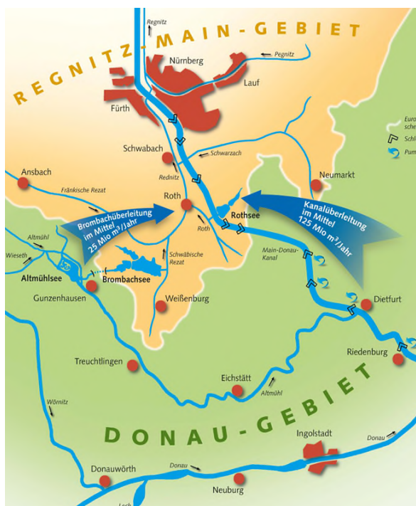
Abb. 18: Das Überleitungssystem im Überblick
