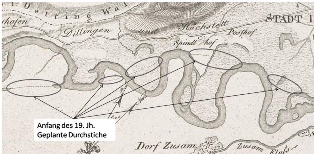
Abbildung 21: Anfang des 19. Jh. geplante Durchstiche oberhalb Donauwörth (zwischen Erlingshofen und Riedlingen) (Riedl)
