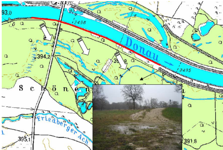
Abbildung 11: Überlaufstrecke vor der Stauhaltung Bertoldsheim
