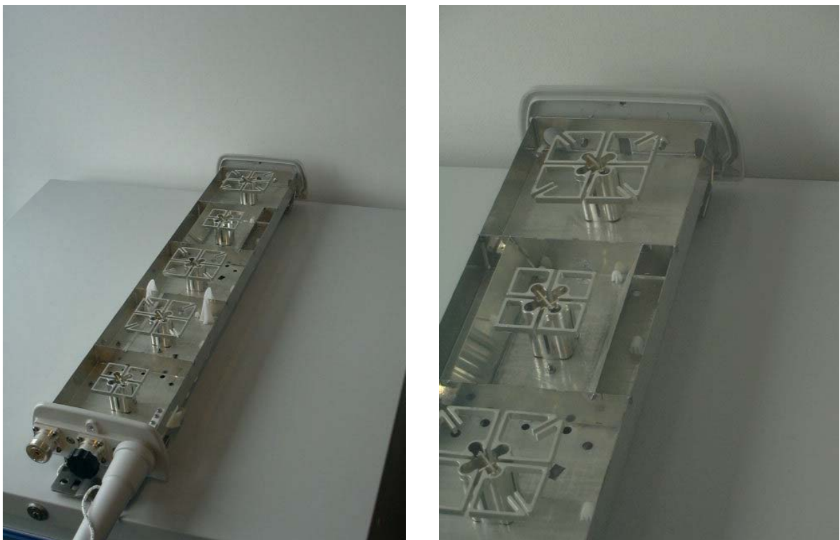
Abb. 4.18: Beispiel für eine Mobilfunkantenne mit Polarisations-Diversity.
