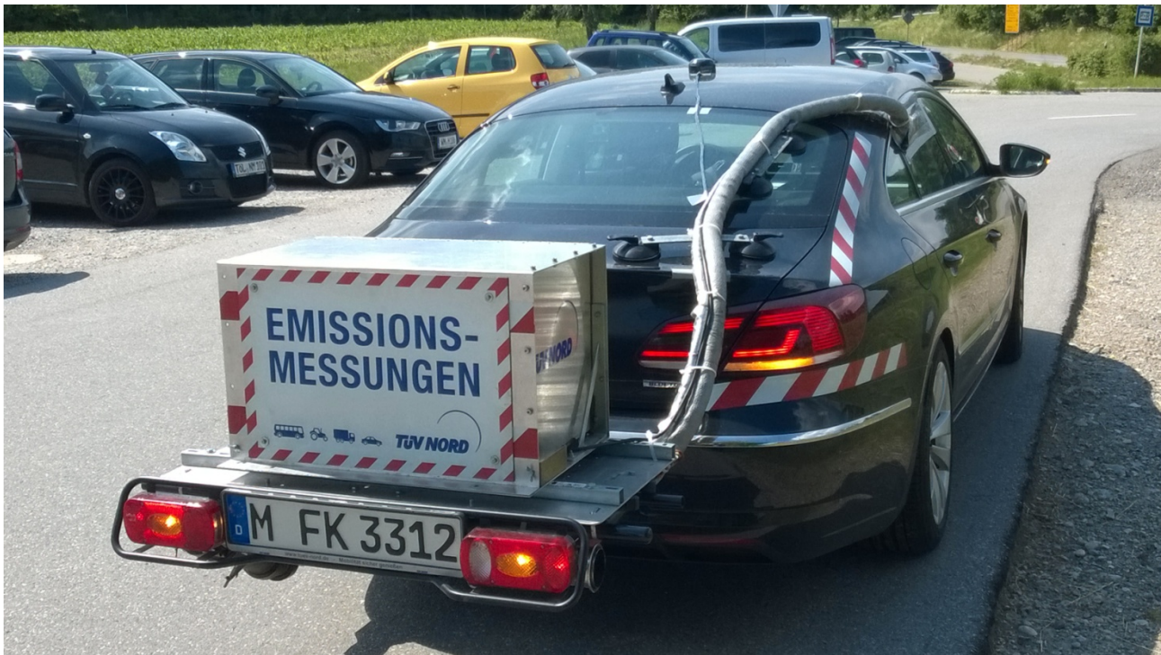
Abbildung 5-3: Messtechnik am Volkswagen
