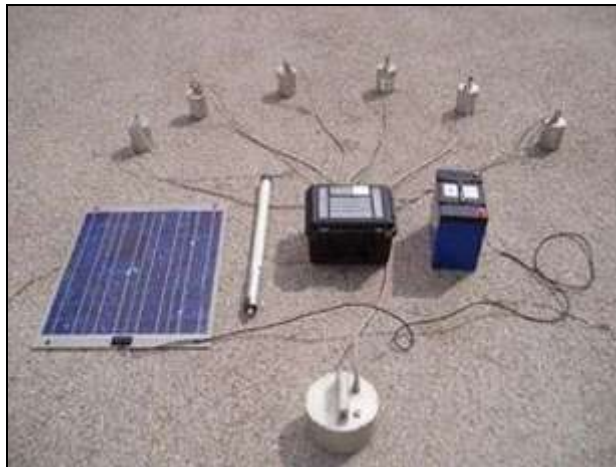
Fig. 39: Seismic array (Roth et al., 2006)
