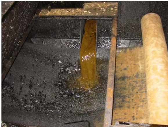
Bandfilter zur Abscheidung fester Stoffe aus dem Waschwasser
