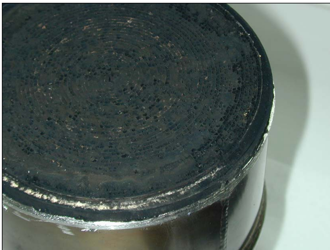
Abbildung 4: Aufnahme des geöffneten Katalysators
