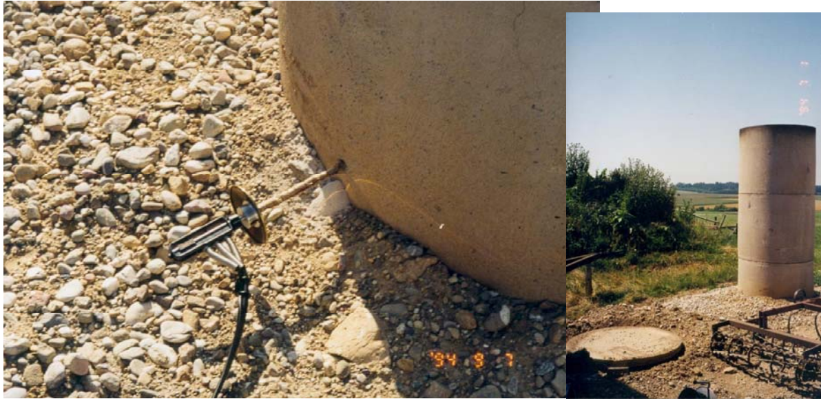
Abbildung 59: Anordnung der Abgas-Messsonde auf Betrieb 5 (Foto vom 09.10.2001)
