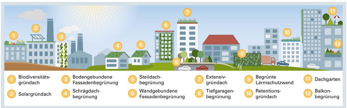
Abb. 13: Das Potenzial für mehr Stadtgrün ist viel größer, als es auf den ersten Blick scheint: Besonders Dächer und Fassaden bieten zusätzlichen Platz für Pflanzen.
