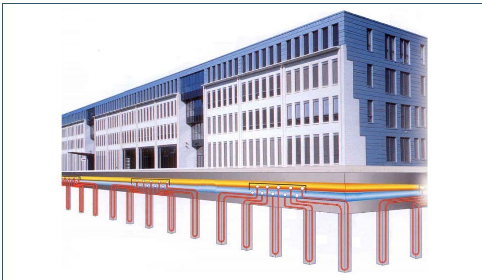
Abb. 6: Erdberührte Betonbauteile – wie die 570 Gründungspfähle unter dieser Industrieanlage – erschließen das Erdreich als Wärme- bzw. Kältequelle. 2
