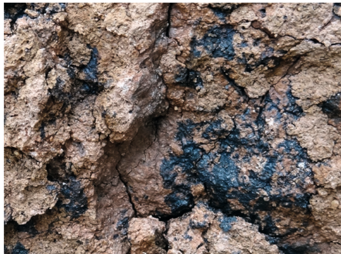
Typische Trockenrisse und dunkle Eisen-Mangan-Flecken
