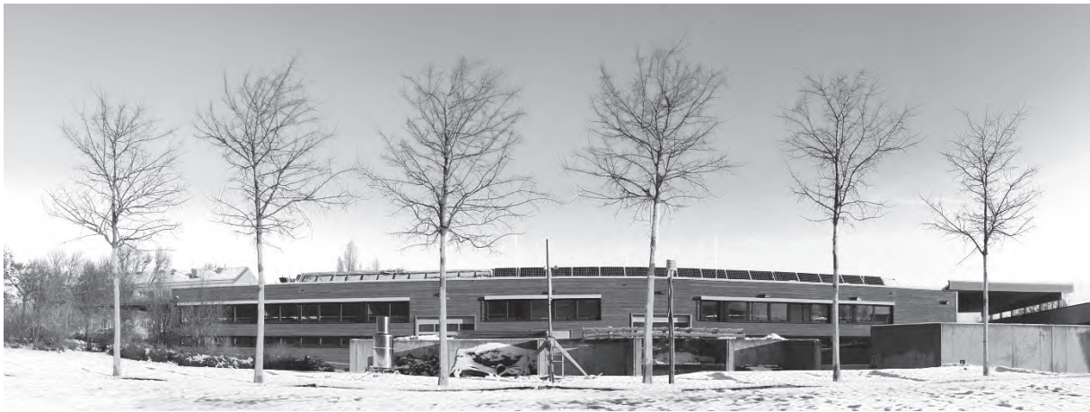
Abbildung: Baum-Lysimeteranlage Jägerhausgasse, Wien (die linken 4 Celtis Australis stehen im nicht überbaubaren Substrat mit Rindemulchabdeckung und die beiden rechten Bäume im überbaubaren Substrat mit wassergebundener Decke)
