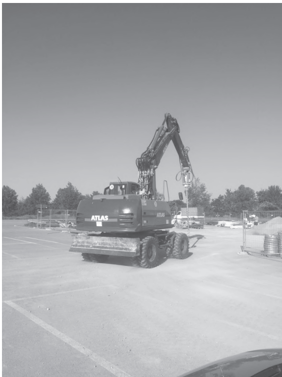
Baggerbohrgerät zur Vorerkundung
