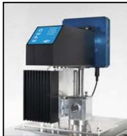
**Headspace-Autosampler mit GC-MS-Kopplung**
