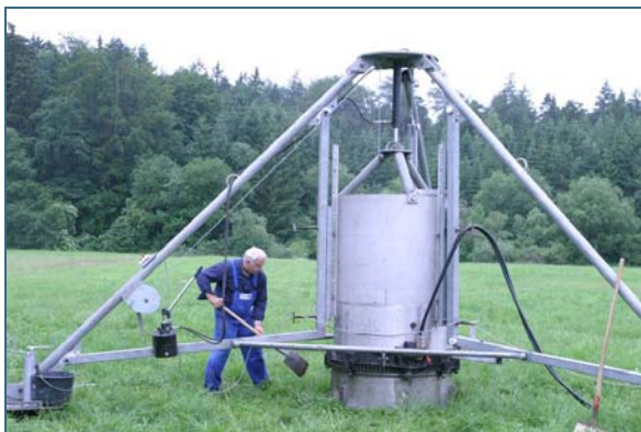
Abb. 1: Aufsetzen des Zylinders auf zu beprobende Fläche
